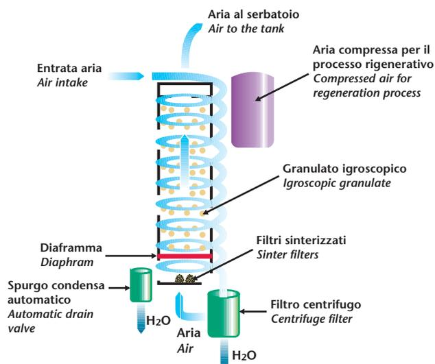
Il principio di funzionamento degli essiccatori ad adsorbimento, processo chimico di separazione della condensa ottenuto con del materiale igroscopico e fisiologicamente innocuo, permette di arrivare ad un punto di rugiada in pressione di -30°C. Inoltre nella fase di rigenerazione automatica dei setacci molecolari, l'umidità catturata dall'essiccatore viene automaticamente scaricata, garantendo un livello costante di purezza dell'aria in uscita per tutto il ciclo operativo dell'essiccatore.
